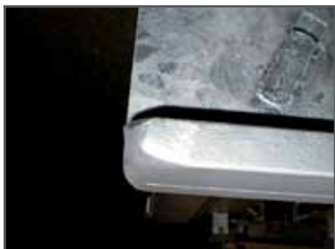
de steunvlakken van de glijvoet zijn afgerond
