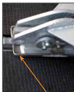
brede steunvlakken voor de trekslede met ronde opstaande rand
