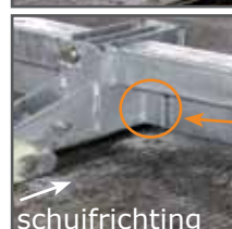
mestklep-aanslag: geen contact met de vloer
