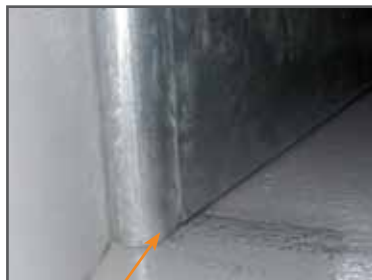
zij mestkleppen let op: scherpe kanten (-> afronden)
