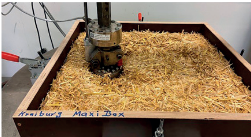
Bild 3: Dauertrittbelastung, Prüfmuster mit Einstreu
