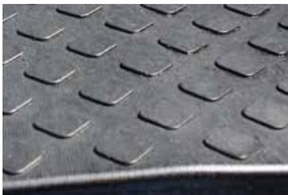
Bild 3: Gewölbte Oberfläche der Matten mit Quadratprägung
