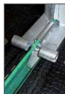
brede steunvlakken voor de trekslede waarbij ronde staven zijn aangebracht
