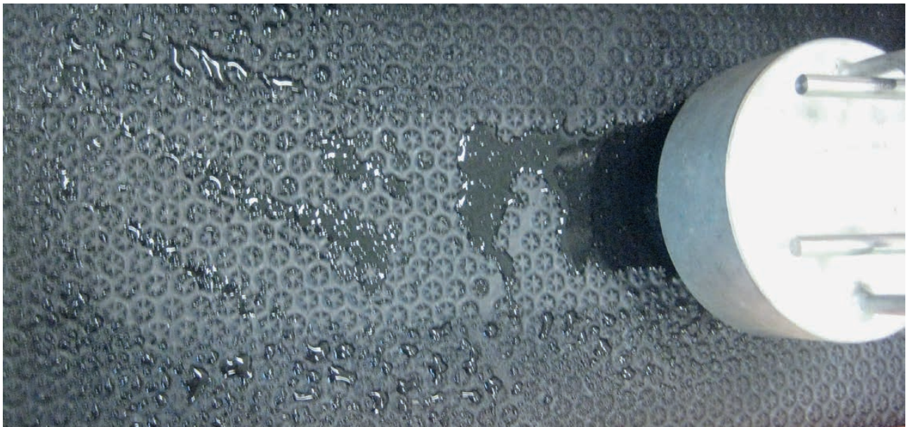
Bild 3: Messung der Rutschfestigkeit in nassem Zustand
