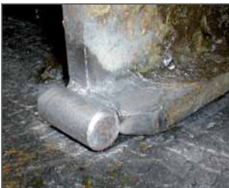
glijvoet met ronde staaf en breed steunoppervlak
