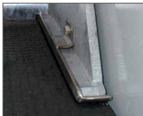
opgeschroefde brede en opstaande glijvoet
