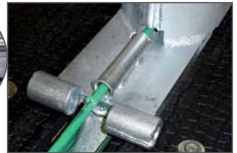
brede steunvlakken voor de trekslede waarbij ronde staven zijn aangebracht
